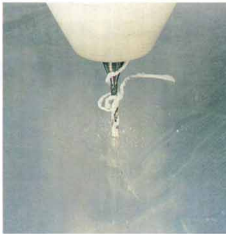
Fig. 6 Perçage du trou de l'axe du verrou avec une fraise de 1 mm (H 206 010).
