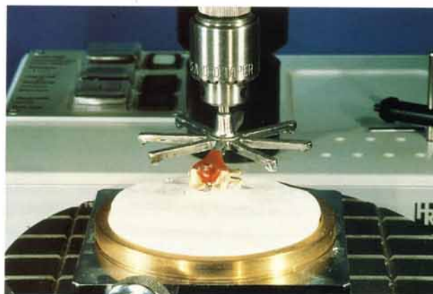
Fig. 21 L'assiette du socle de fraisage et les télescopes primaires (sur le bloc de métal et solidarisés à l'étoile).
