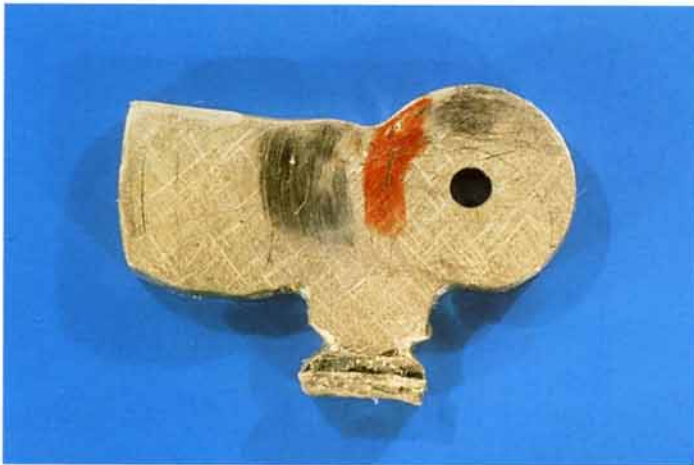
Fig. 41 Afin de pouvoir définir avec précision l'emplacement de la future cuvette dans laquelle viendra se loger le bouton-pression pour bloquer le verrou en position fermée, on enduit de stylo feutre la surface du pêne puis on l'actionne. Le frottement du bouton-pression contre le pêne laisse alors une trace.
