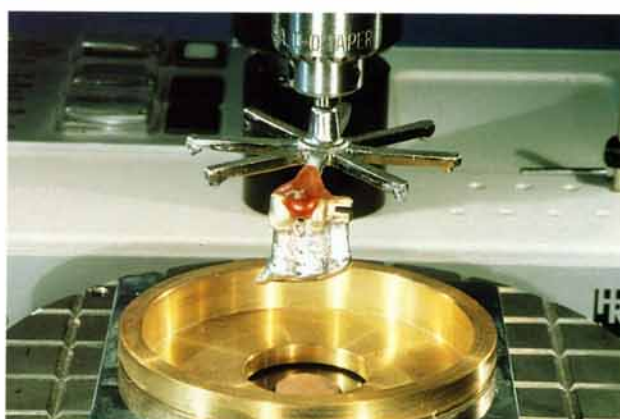
Fig. 21 L'assiette du socle de fraisage et les télescopes primaires (sur le bloc de métal et solidarisés à l'étoile).
