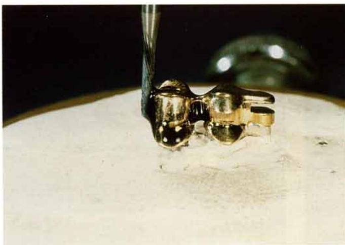
Fig. 23 Fraisage des télescopes primaires en utilisant de l'huile de fraisage.
