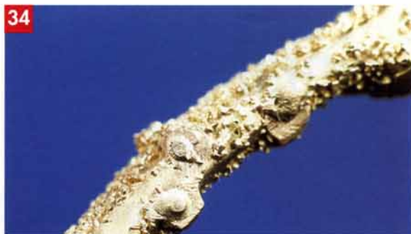
Photo 34 : Cette brasure demande la plus grande concentration. En effet, seul l'endroit visible sur la photo doit être soudé, en aucun cas la soudure ne doit fuser le long de la tige. Celle-ci doit rester libre et activable, c'est-à-dire, pliable. Si elle était soudée, elle n'aurait plus aucune utilité.
