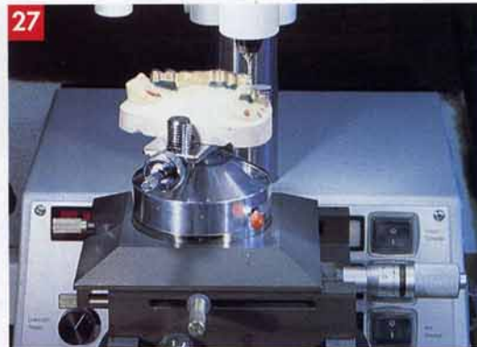
Photo 27 : pour mieux se faire une idée de la précision d'un tel travail, voici la fraiseuse H+R DFU 222 avec sa table micrométrique d'une extrême précision pour du matériel dentaire. Capable de tourner à 50 000 T/min son moteur haute fréquence lui confère un couple sans égal ; quant à la table micrométrique on peut observer les deux palmers devant et à droite qui assurent le déplacement de l'objet à fraiser au centième de mm.
