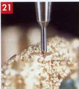
Photo 21 : Le travail s'effectue de préférence sur le socle de fraiseuse. J'ai donc remplacé la suprastructure et j'amorce le perçage, c'est-à-dire que j'utilise un foret à centrer très stable n'ayant qu'un plan de coupe ponctuel, (N° H 370 009).
