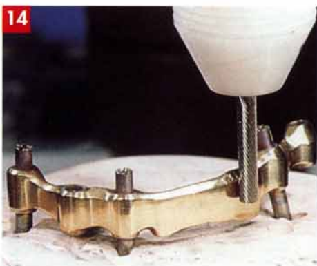
Photo 14 : Plusieurs facteurs sont importants en fraisage : la vitesse de rotation, la vitesse de déplacement de la fraise de gauche à droite, la force avec laquelle on presse la fraise contre la surface à fraiser, la mélodie de la fraise sur le métal donne une excellente indication : elle doit ronronner régulièrement et non pas hurler avec des cris stridents, les vibrations dans les doigts sont également très éloquentes pour qui veut bien les ressentir.
