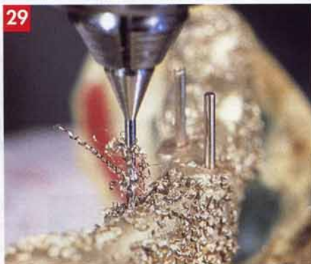
Photo 29 : Deux tiges de friction sont déjà en place et le forage continu.
