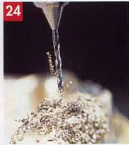
Photo 21 : Le travail s'effectue de préférence sur le socle de fraiseuse. J'ai donc remplacé la suprastructure et j'amorce le perçage, c'est-à-dire que j'utilise un foret à centrer très stable n'ayant qu'un plan de coupe ponctuel, (N° H 370 009).
