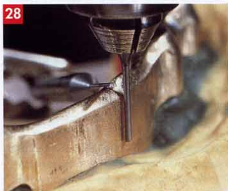
Photo 28 : Sur cette photo on voit deux fraises canon, une à 1/10 de la barre fraisée, l'autre couchée et l'on peut mieux comprendre la forme en coupe évoquée précédemment.
