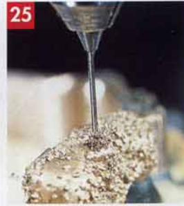
Photo 21 : Le travail s'effectue de préférence sur le socle de fraiseuse. J'ai donc remplacé la suprastructure et j'amorce le perçage, c'est-à-dire que j'utilise un foret à centrer très stable n'ayant qu'un plan de coupe ponctuel, (N° H 370 009).
