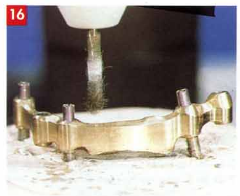
Photo 14 : Plusieurs facteurs sont importants en fraisage : la vitesse de rotation, la vitesse de déplacement de la fraise de gauche à droite, la force avec laquelle on presse la fraise contre la surface à fraiser, la mélodie de la fraise sur le métal donne une excellente indication : elle doit ronronner régulièrement et non pas hurler avec des cris stridents, les vibrations dans les doigts sont également très éloquentes pour qui veut bien les ressentir.
