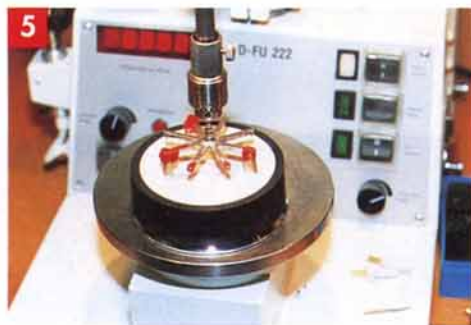
Photo 5 : les moignons métalliques sont noyés dans le plâtre pour réaliser le socle de fraisage.
