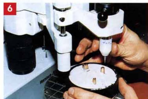
Photo 6 : le fraisage du métal peut commencer à l'aide d'une fraise à 6^\circ .
