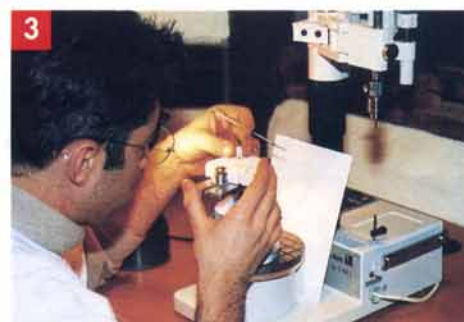
Photo 3 : recherche du meilleur axe en ombre chinoise à l'aide d'un papier blanc.
