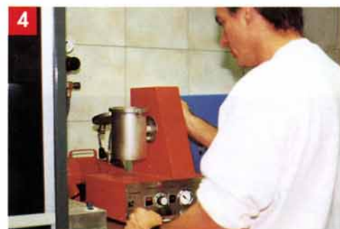
Photo 4 : la coulée au Combilabor n'induit pas de force centrifuge, n'occasionne pas de surchauffe du métal, ni de pollution. Les coulées sont très précises et présentent une grande qualité métallurgique.
