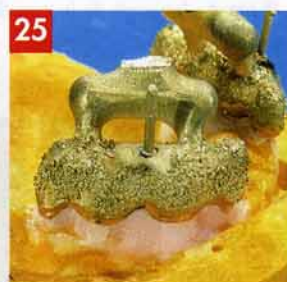
Photo 25 : la suie dégagée par la soudure à l'arc par point est sablée à l'oxyde d'aluminium 50 my (30B de H + R) dans une sableuse H + R PG 4/4.
