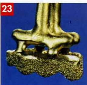
Photo 23: la coulée au Combi Labor se fait sans force centrifuge, sans atmosphère, sous vide. Grâce à la résistance le métal fond mais n'est jamais surchauffé.
