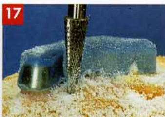
Photo 17: toujours à l'aide de la fraise à 6° et sans oublier de régler le conomètre sur les bons chiffres, j'usine la résine. Ayant la même orientation que pour l'or, j'obtiens ainsi pour les parties secondaires, une épaisseur uniforme d'environ 3/10 de mm. La précision à la coulée n'en sera que plus grande ; il est à noter que les différences de volumes sont à la base de bien des problèmes de coulée, le métal ne figeant pas de façon uniforme.
