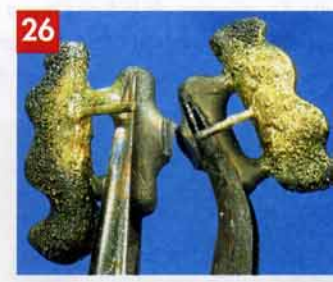
Photo 26 : les 2 Ceka Revax sont brasés sans qu'il soit nécessaire de les relier autrement que par cette petite soudure. Aucune masse souder, gros grain ou autre, n'est utilisée. Les attachements sont brasés librement au chalumeau sans préchauffage comme c'est le cas avec une masse à souder ; le gain de temps est énorme.
