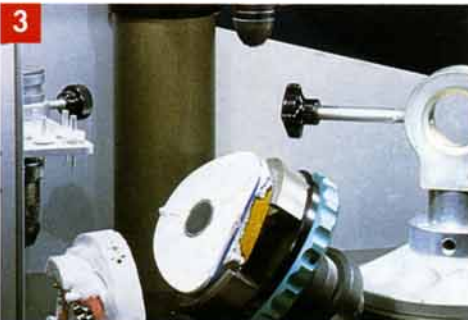
Photo 3 : à droite l'accessoire de positionnement à 90° fixé dans le socle, au centre la table à rotule portant le Splitfix à gauche le modèle.
