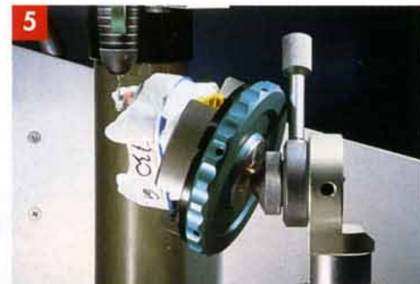
Photo 5 : les trois pièces assemblées et le modèle placé à 90° par rapport à la fraise.
