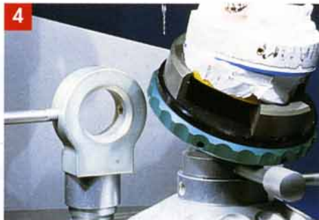
Photo 4 : on voit la table à rotule sur son socle, à gauche l'accessoire de positionnement à 90°.
