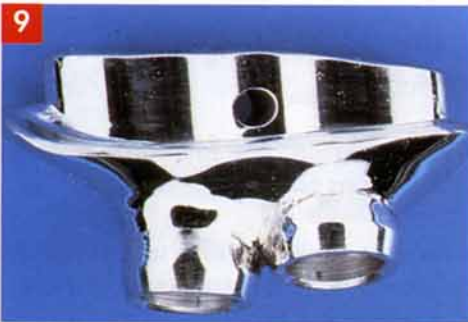
Photos 9 et 10 : fraisage terminé. Le passage de la clavette a été foré à 90°.
