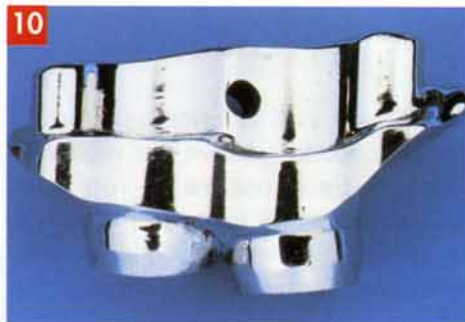
Photos 9 et 10 : fraisage terminé. Le passage de la clavette a été foré à 90°.
