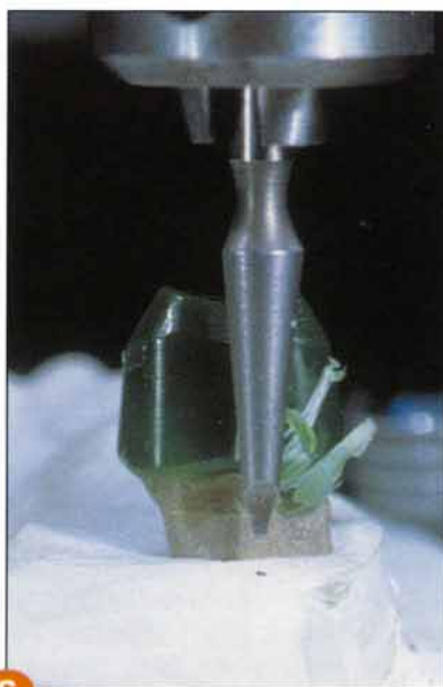
Fig. 6 Grattage à froid de la cire à l'aide d'un grattoir à 6°. On voit les copeaux de cire.
